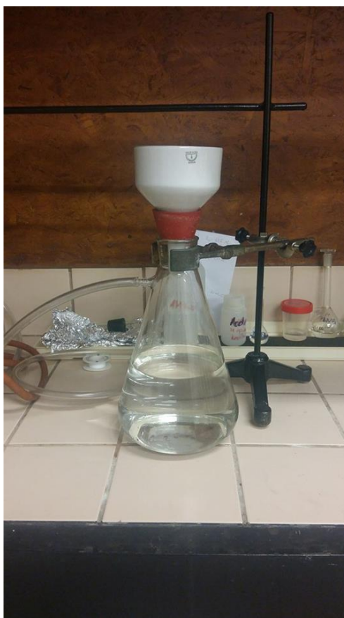
Slika 3.6. Filtriranje rGO kroz Buchnerov lijevak
