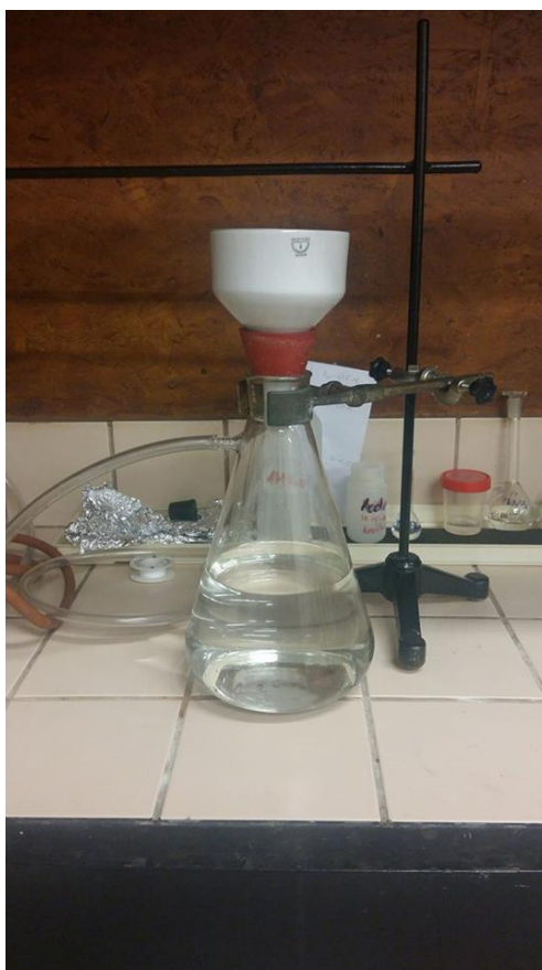
Slika 3.6. Filtriranje rGO kroz Buchnerov lijevak
