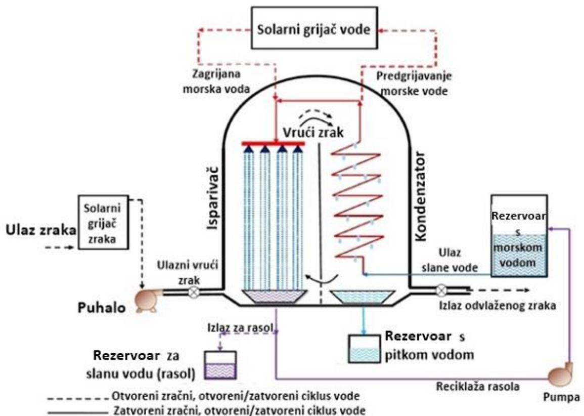
**Slika 2.2.** Desalinacija solarnom humidifikacijom-dehumidifikacijom
