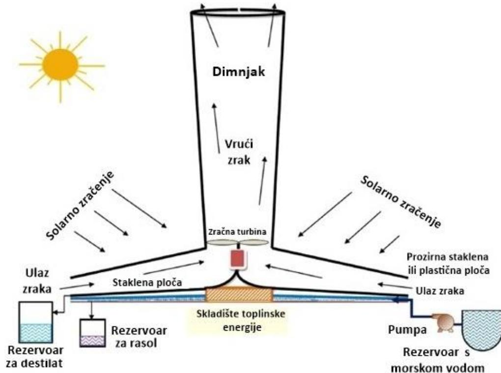
**Slika 2.3.** Integracija solarnog dimnjaka i procesa desalinacije
