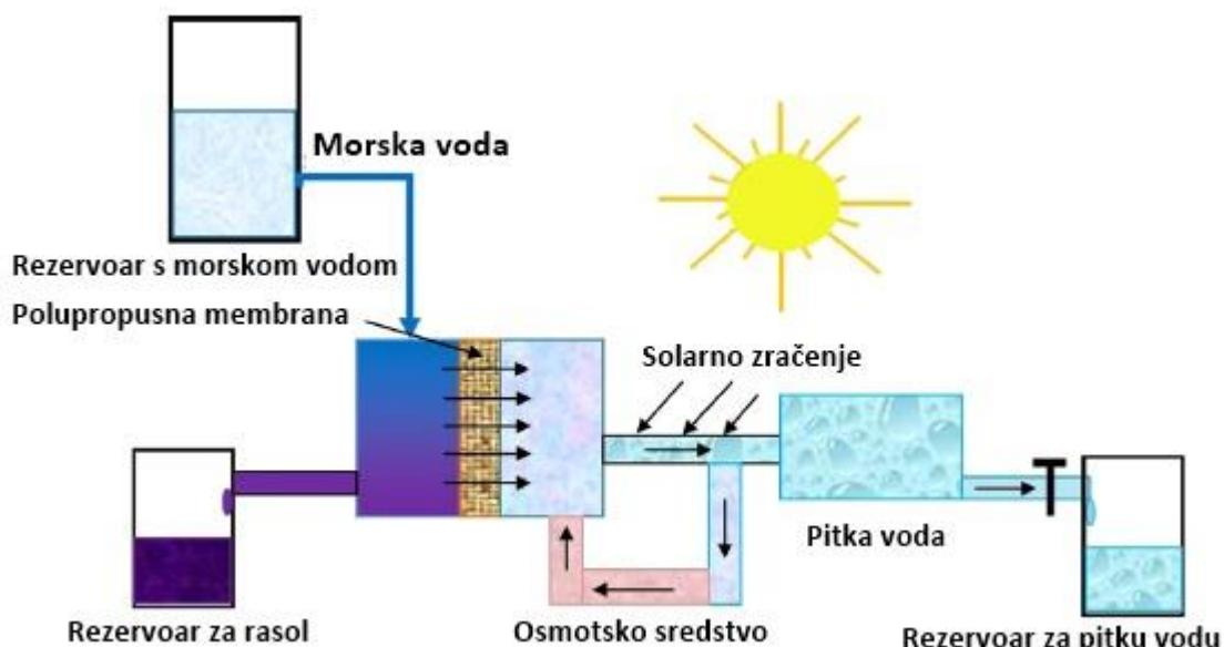
**Slika 2.26.** Desalinacija solarnom naprednom osmozom
