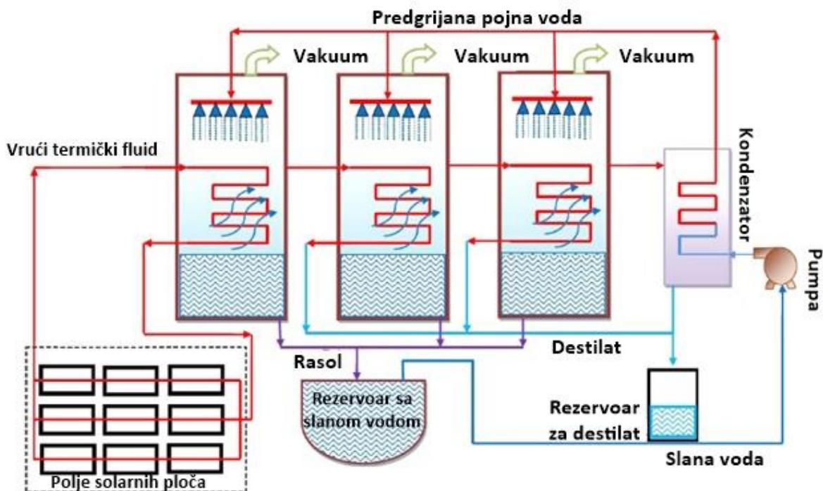
**Slika 2.6.** Solarna desalinacija višefaznom destilacijom
