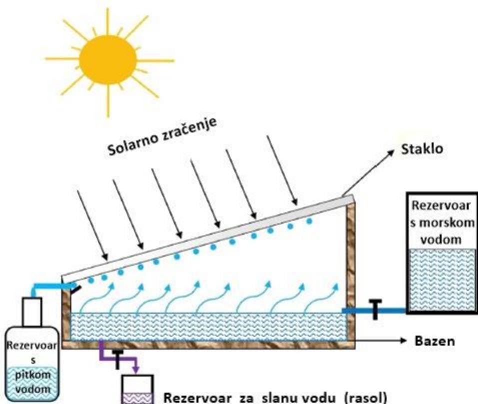
**Slika 2.1.** Jednostavni solarni kotao
