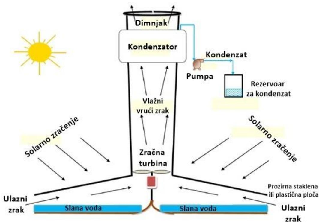
**Slika 2.4.** Izravna kombinacija postupka desalinacije sa solarnim dimnjakom
