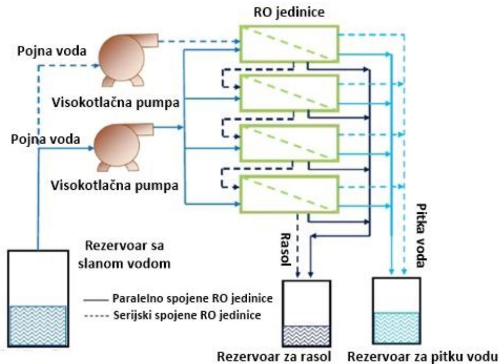
**Slika 2.16.** Serijsko i paralelno spajanje RO jedinica
