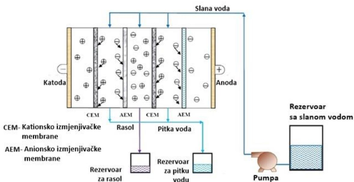
**Slika 2.19.** Desalinacija elektrodijalizom
