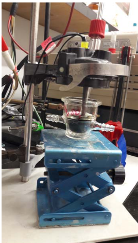
Slika 3.2. Elektrokemijska ćelija s a) dvoelektrodnim sustavom korištena za elektrokemijsko raslojavanje grafita i b) troelektrodnim sustavom korištena tijekom snimanja cikličkih voltamograma
