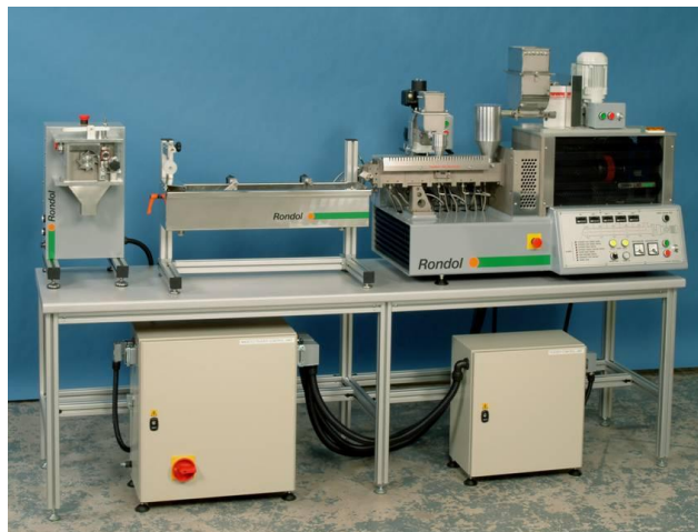
Slika 26. Ekstruder Rondol 21mm LAB TWIN
