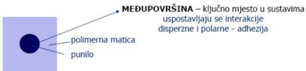
Slika 18. Prikaz međupovršine matica - punilo
