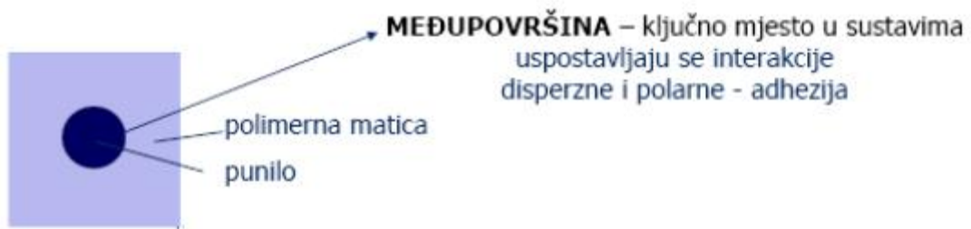
Slika 18. Prikaz međupovršine matica - punilo
