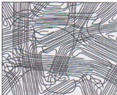
Slika 13. Shematski prikaz rasporeda makromolekula u polietilenu
