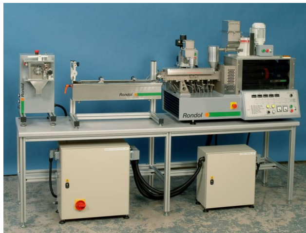
Slika 28. Ekstruder Rondol 21mm LAB TWIN
