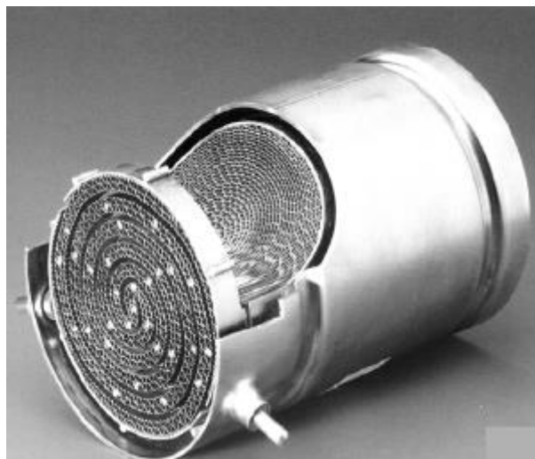
Slika 2.9. Električni grijani katalitički pretvornik
