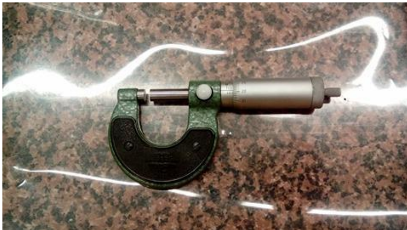
Slika 3.9. Uređaj za određivanje debljine listova
