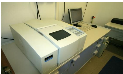
Slika 3.5. FTIR spektrofotometar Perkin Elmer Spectrum One
