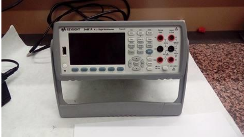
Slika 3.8. Uređaj za mjerenje električnog otpora Keysight 34461 6 1/2 Digit Multimeter
