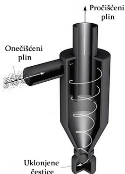
Slika 12. Sustavi za suho otprašivanje – svijećasti filtri (lijevo) i ciklon (desno)<sup>2, 15</sup>
