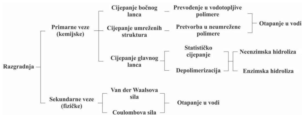
Slika 3. Mehanizmi razgradnje polimera
