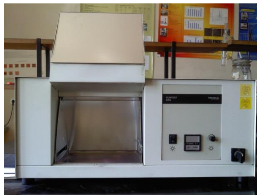
Slika 12. UV komora SUNTEST
