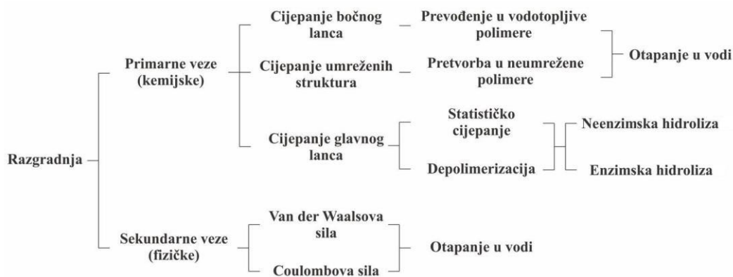
Slika 3. Mehanizmi razgradnje polimera
