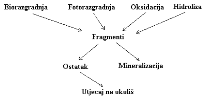
Slika 4. Međusobna povezanost razgradnih procesa polimernih materijala u okolišu 6
