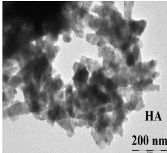
**Slika 6.** TEM mikrograf HA sinteriranog na  $900^{\circ}\text{C}$ .
