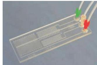
Slika 2. Slika mikroreaktora izrađenog od borsilikatnog stakla [4]
