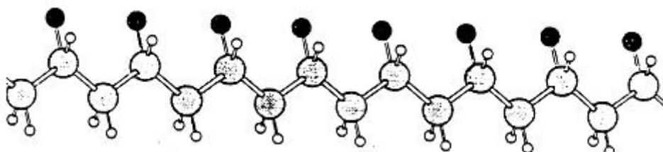
Slika 18. Struktura izotaktnog polipropilena [34]
