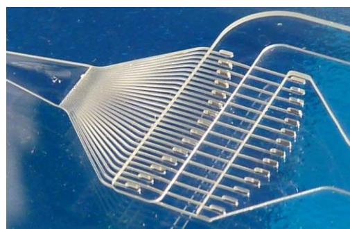
Slika 5. Mikroreaktor izrađen iz foturan stakla [10]
