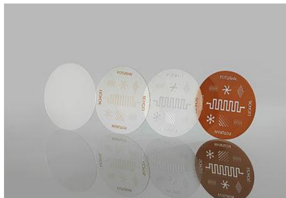
Slika 4. Izgled mikroreaktora izrađenog od foturan stakla tijekom procesa obrade [9]
