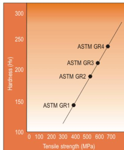
Slika 23. Prikaz ovisnosti tvrdoće o vlačnoj čvrstoći titanija [43]
