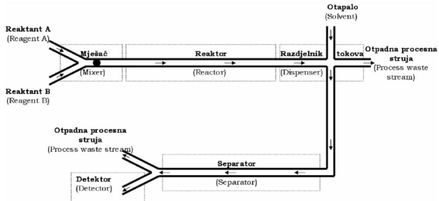
Slika 1. Shematski prikaz jedne  $\mu$ -TAS jedinice [2]
