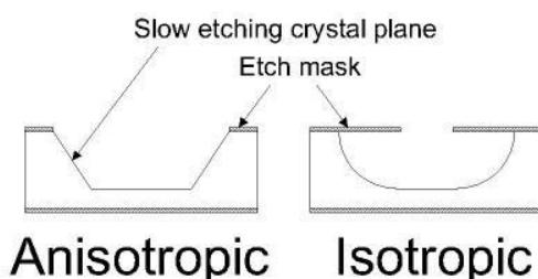
Slika 24. Primjer izotropnog i neizotropnog stvaranja mikrostruktura [54]
