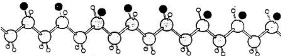
Slika 20. Struktura ataktnog polipropilena [34]
