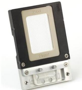
Slika 6. Mikroreaktor izrađenog od kvarcnog stakla volumena  $250\mu\text{L}$  [13]
