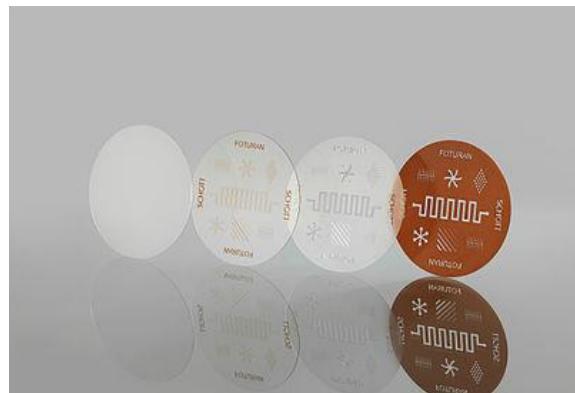
Slika 4. Izgled mikroreaktora izrađenog od foturan stakla tijekom procesa obrade [9]
