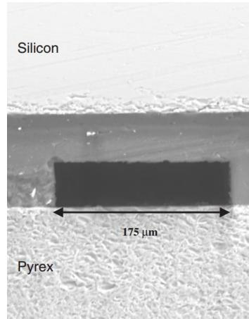
Slika 13. SEM fotografija koja prikazuje strukturu mikrokanala [24]
