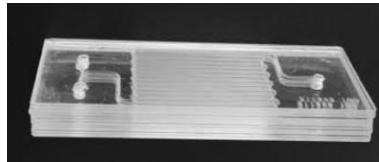
Slika 3. 10 slojeva mikroreaktora izrađenih od PYREX® stakla [8]
