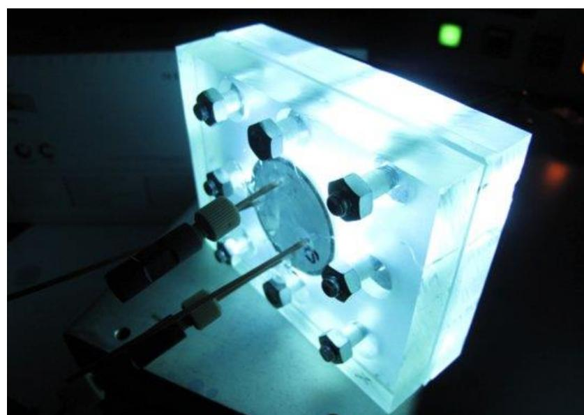
Slika 16. PMMA fotokatalitički mikroreaktor [32]
