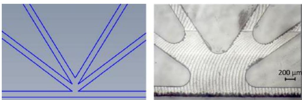
Slika 8. Slika proizvedenog mikroreaktora na bazi PDMS [16]
