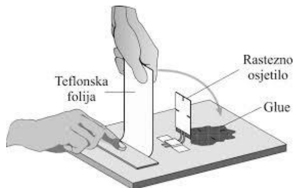
Slika 19. Postupak pričvršćivanja osjetila na površinu [4]
