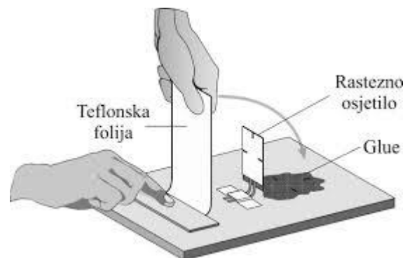
Slika 19. Postupak pričvršćivanja osjetila na površinu [4]
