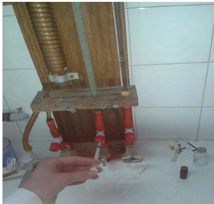
Slika 16. Prikaz unošenja trasera u sustav
