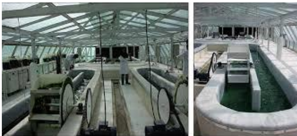
Slika 3.2. Otvoreni sustavi za uzgoj mikroalgi 6
