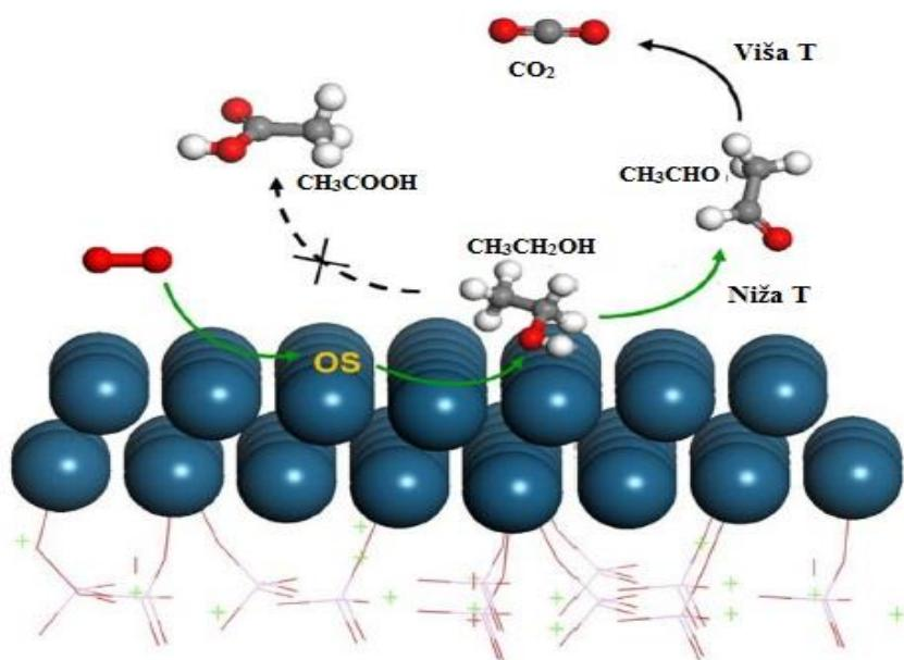
**Slika 9.** Prikaz mehanizma za selektivnu oksidaciju etanola na Ag/HAP
