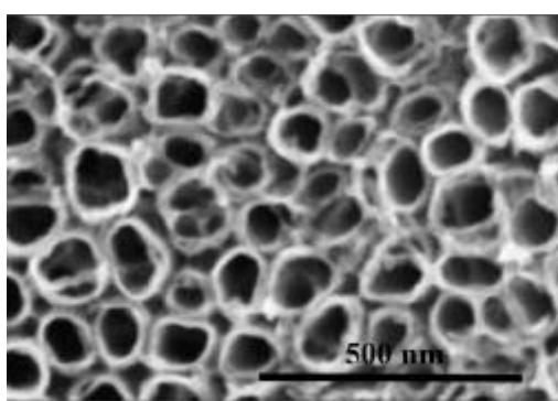
Slika 13. SEM prikaz uredno poredanih nanocjevčica  $\text{TiO}_2$
