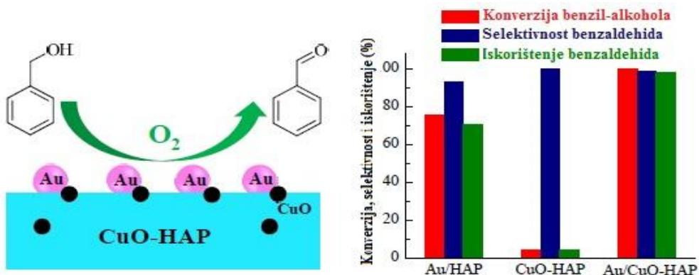
**Slika 12.** Usporedba konverzije, selektivnosti i iskorištenja benzaldehida s razl. katalizatorima
