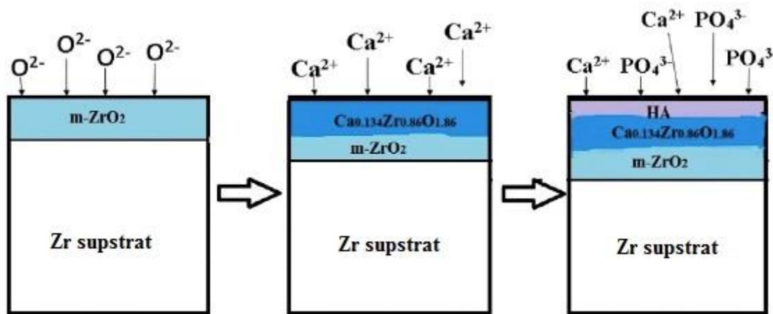
Slika 8. Mehanizam formiranja HAP sloja na Zr supstratu
