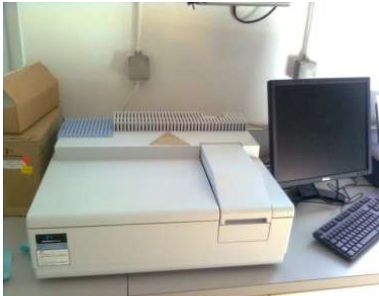
Slika 3. 1. UV/VIS spektrofotometar Lambda 35 (PerkinElmer, Waltham, SAD)
