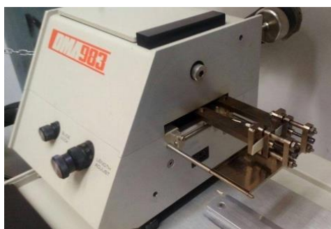
Slika 9. DMA 983 TA instruments
