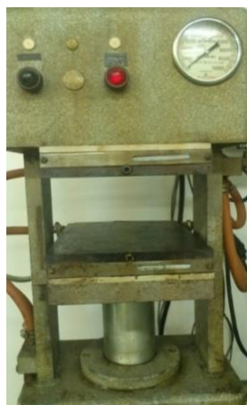
Slika 7. Hidraulička preša Dake Model 44-226
