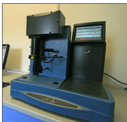
Slika 10. Termogravimetar, Q500,TA Instruments
