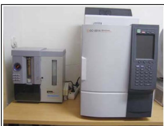
*Slika 3.2. Plinski kromatograf Shimadzu GC – 2014 i Parker 9150 generator vodika*
