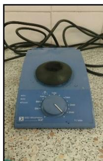
**Slika 3.6. Homogenizator**
