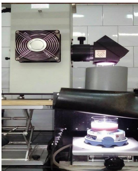
Slika.3.8. Oriel Newport (Osram XBO 450W lampa)
