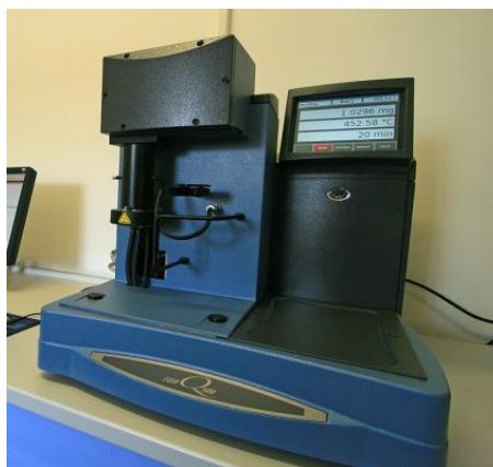
Slika 3.3. Termogravimetar Q500 TA Instruments
