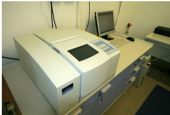
Slika 3.2. FTIR uređaj Perkin Elmer Spectrum One
