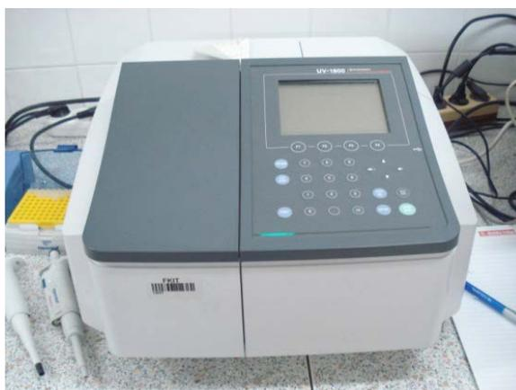
Slika 3. UV/VIS spektrofotometar
