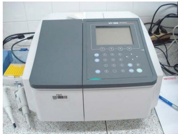
Slika 3. UV/VIS spektrofotometar
