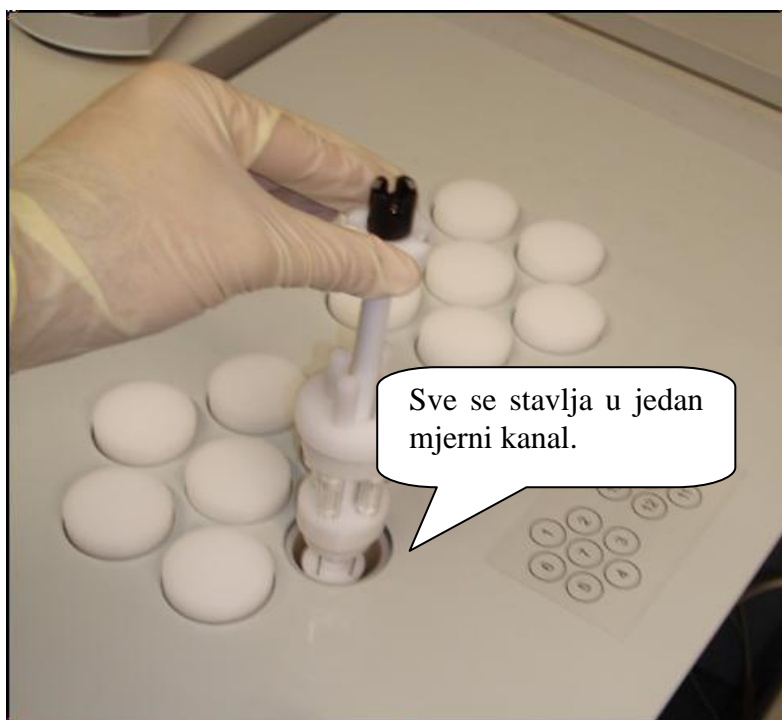
Slika 27. Umetanje MC CAL u mjerni kanal
