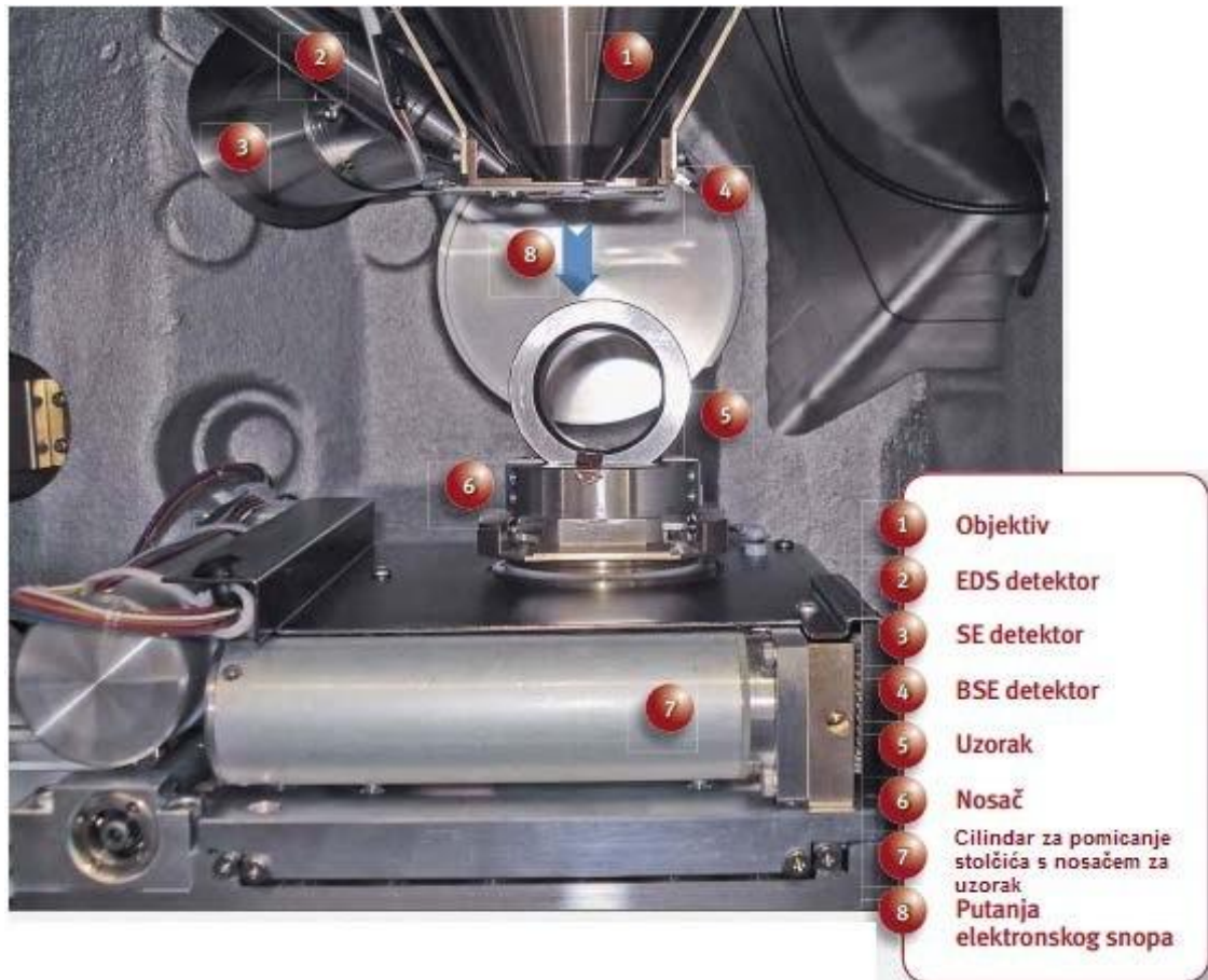
Slika 12. Unutrašnjost komore SEM-a za uzorke [11]
