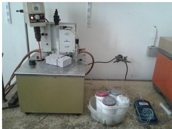
Slika 17. Pojednostavljeni prikazi eksperimentalnog postava semi-adijabatskog kalorimetra.
