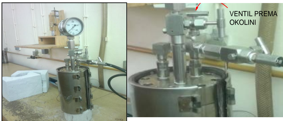
Slika 21. Hidrotermalni reaktor, Zavod za anorgansku kemijsku tehnologiju i nemetale
