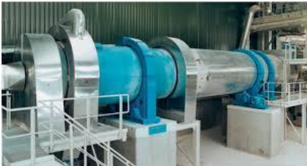
Slika 6. Rotacijski kalcinator gipsa [5]
