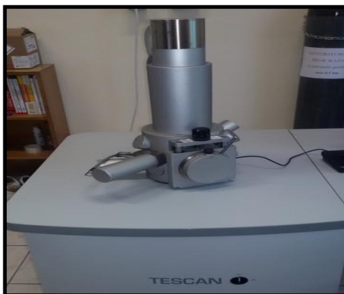
Slika 24. Elektronski mikroskop SEM-TESCAN VEGA TS5236LS
