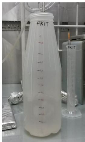
Slika 19. Reaktor u kojem se vodio proces biorazgradnje
