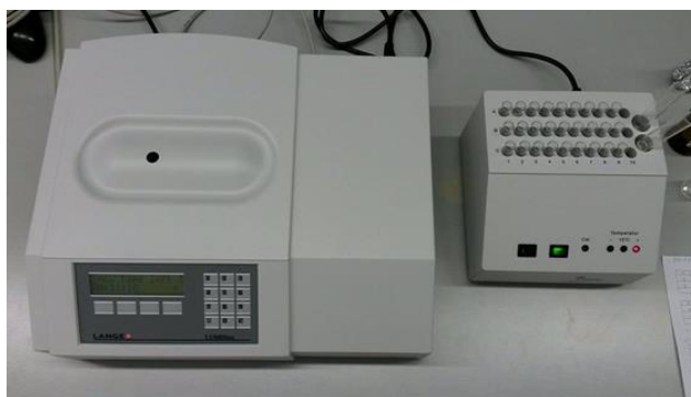
Slika 18. Uredaj za provedbu toksičnosti (LUMISTox 300)
