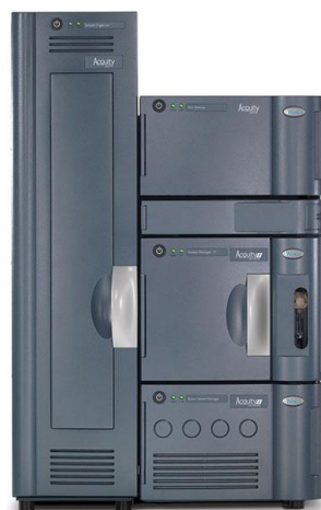
Slika 17. Tekućinski kromatograf ultravisoke djelotvornosti [48]
