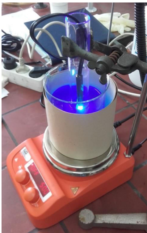
Slika 31. Slika aparature korištene za fotodegradaciju metilenskog modrila
