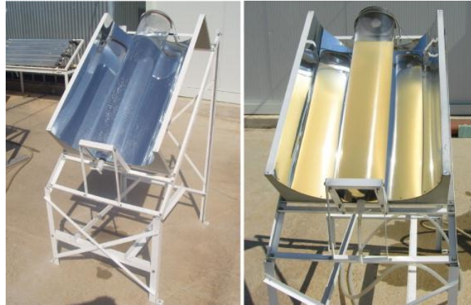
Slika 11. Postupak dezinfekcije vode UV zračenjem [54].
