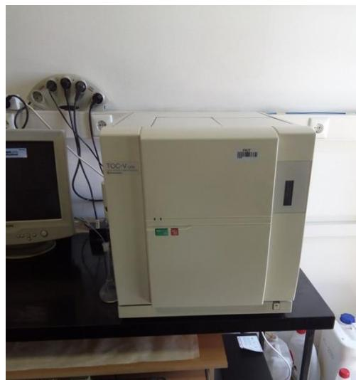
**Slika 8.** TOC analizator, TOC-VCPN, Shimadzu.
