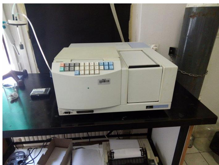
**Slika 11.** UV/VIS spektrofotometar, Perkin Elmer Lambda EZ 201.
