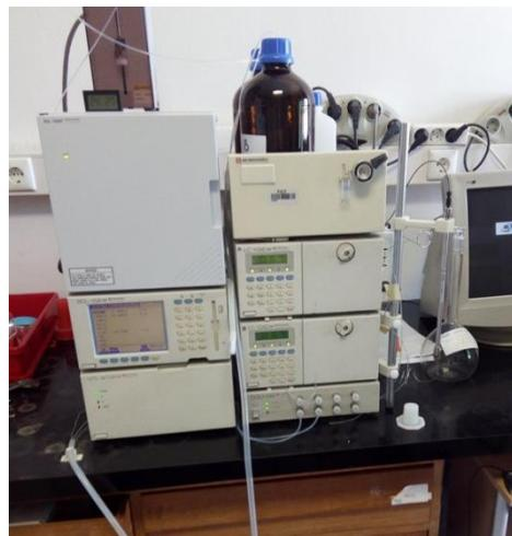
Slika 9. HPLC uređaj, Shimadzu Series 10.
