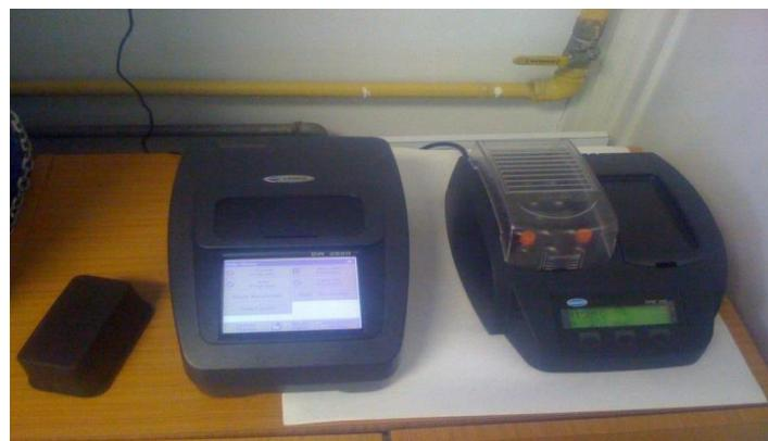
**Slika 7.** DR 2800 spektrofotometar i termoblok Hach Lange.
