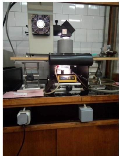
**Slika 13.** Proces uklanjanja diklofenaka iz vode pod simuliranim Sunčevim zračenjem.
