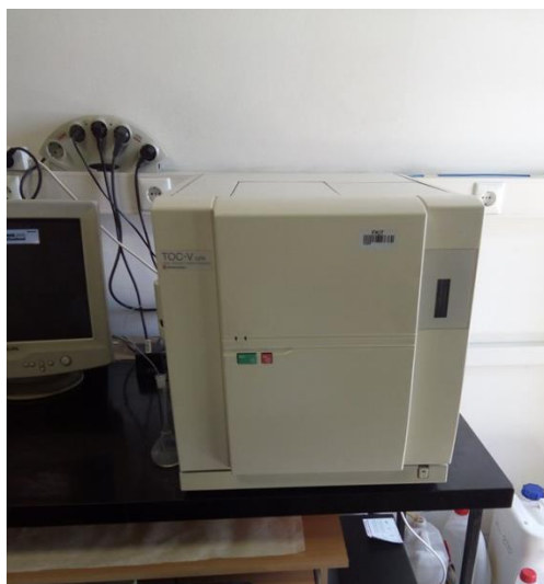
Slika 8. TOC analizator, TOC-V CPN , Shimadzu.
