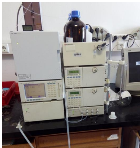
Slika 9. HPLC uređaj, Shimadzu Series 10.
