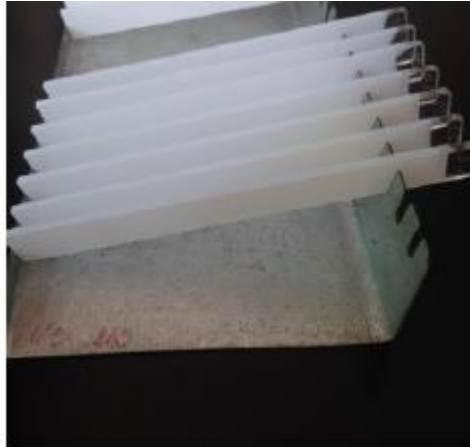
Slika 15. Staklene pločice s imobiliziranim fotokatalizatorom
