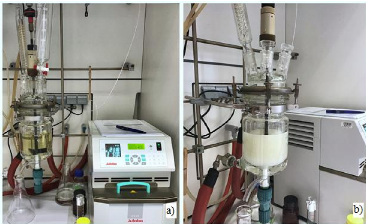
Slika 3.6. Oksidacija DAS-a vodikovim peroksidom prije (a) i poslije kristalizacije (b).
