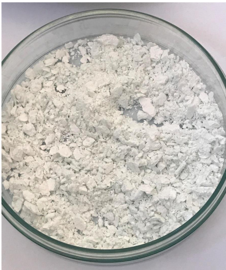
Slika 4.1. DAS N-oxid dobiven oksidacijom DAS-a vodikovim peroksidom
