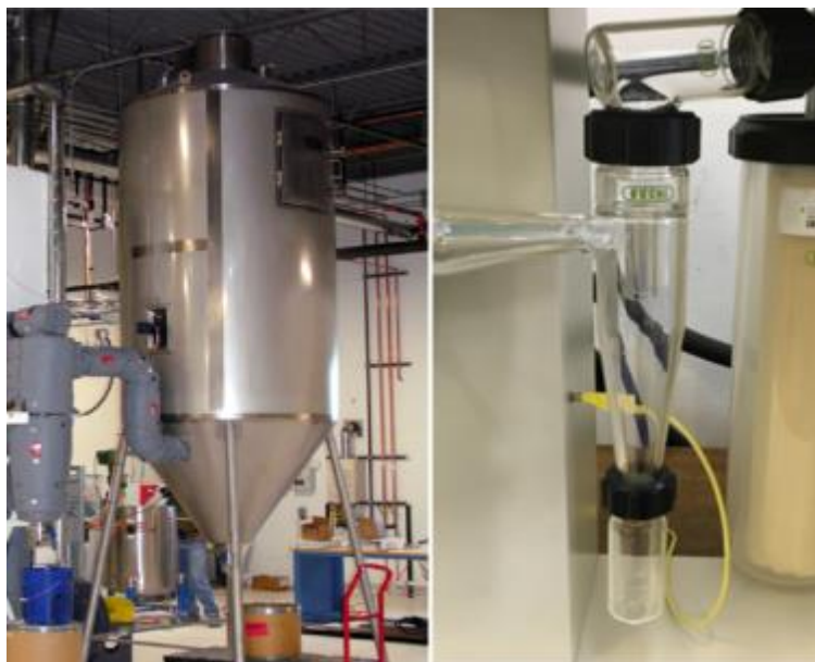
Slika 9. Prikaz ciklona (lijevo – industrijski, desno – laboratorijski)
