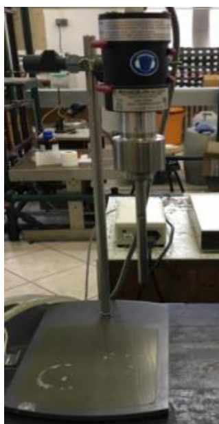
Slika 19. Ultrazvučni homogenizator Bandelin sonoplus HD 3200
