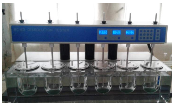
Slika 24. Uređaj za ispitivanje kinetike otpuštanja djelatne tvari RC-6D, Zhengzhou Nanbei Instrument
