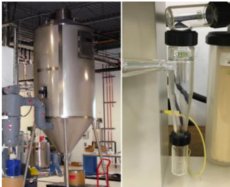
Slika 9. Prikaz ciklona (lijevo – industrijski, desno – laboratorijski)
