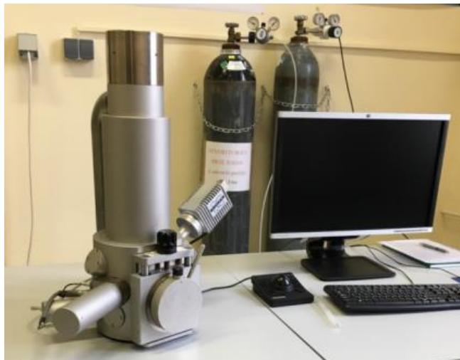
Slika 23. Tescan Vega 3 SEM, naporivač (sputtercoater) Quorum SC7620
