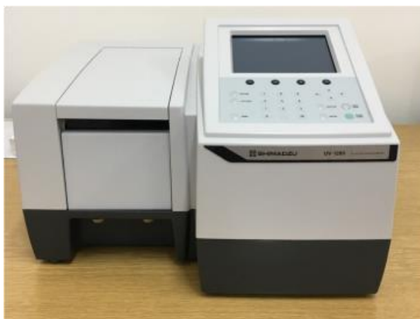
Slika 22. UV/ Vis spektrofotometar Shimadzu, UV-1280
