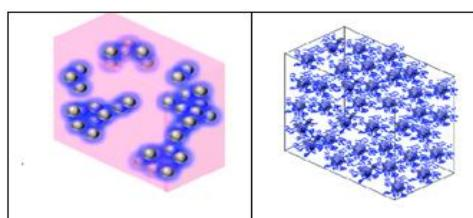
**Slika 1.** Prikaz strukture polimernog nanokompozita s<sup>2</sup> a) prisutnim aglomeratima; b) bez prisutnosti aglomerata.
