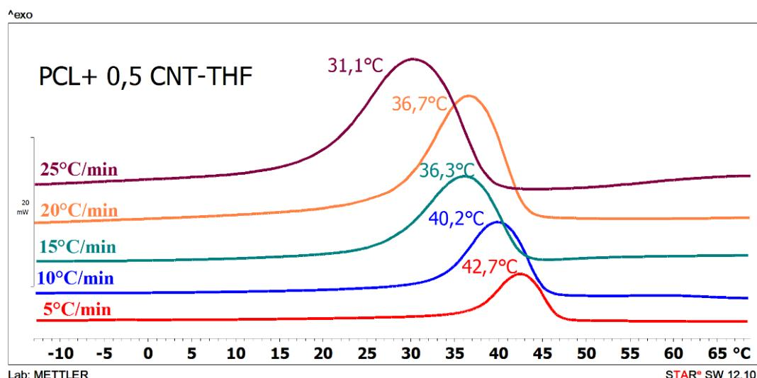
**Slika 25.** Egzotermi kristalizacije dobiveni na različitim brzinama hlađenja za PCL i PCL+0,5mas% CNT nanokompozit dobivenog umiješavanjem u Brabender gnjitelici i THF-
