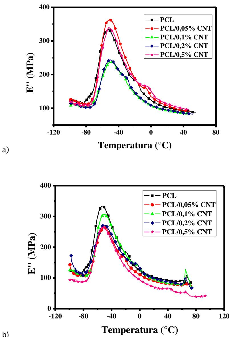
**Slika 27.** Krivulja modula gubitka u ovisnosti o temperaturi za PCL i PCL/CNT nanokompozite pripravljene u a) Brabender gnjetilici i b) THF-u.
