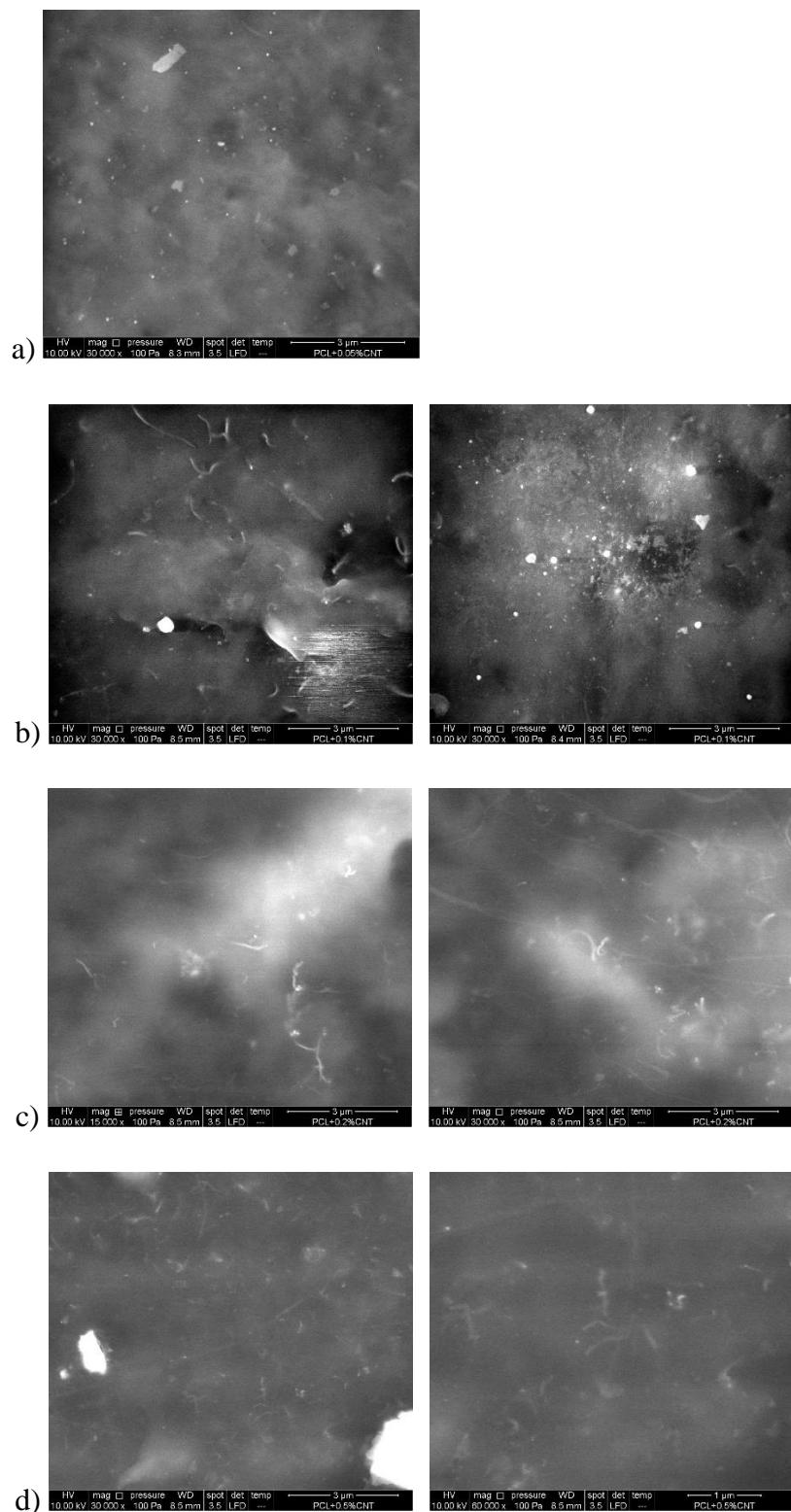
**Slika 20.** SEM mikroografi PCL/CNT nanokompozita pripravljenih umiješavanjem u Brabender gnjetilici s a) 0,05 mas% CNT, b) 0,1 mas% CNT, c) 0,2 mas% CNT, d) 0,5 mas% CNT pri različitim uvećanjima.
