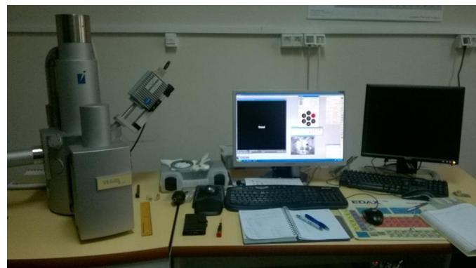
**Slika 18.** Pretražni elektronski mikroskop FEG SEM QUANTA 250.
