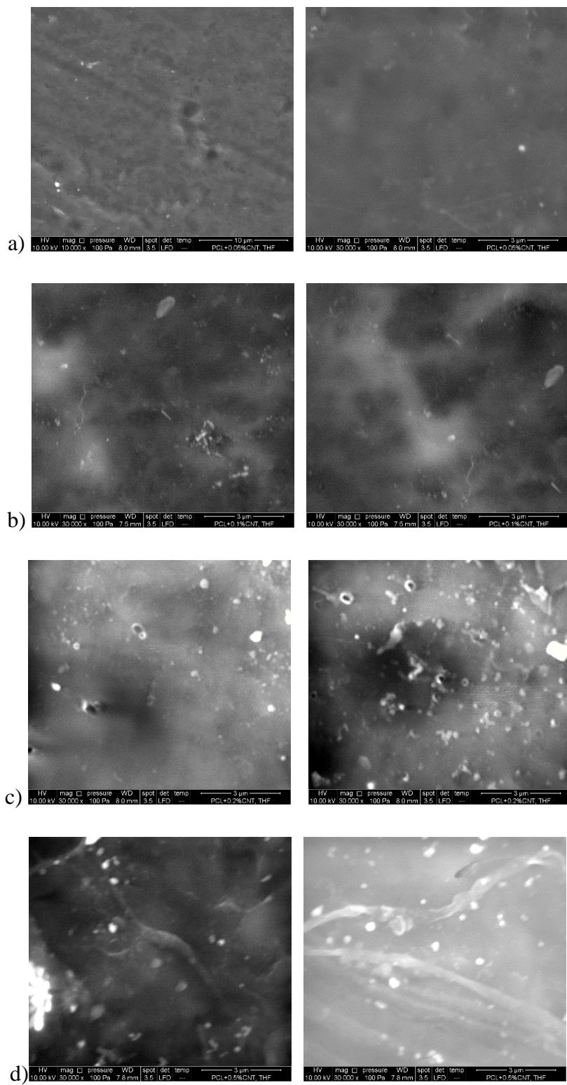
**Slika 21.** SEM mikroografi PCL/CNT nanokompozita pripravljenih otapanjem u THF-u s a) 0,05 mas% CNT, b) 0,1 mas% CNT, c) 0,2 mas% CNT, d) 0,5 mas% CNT pri različitim uvećanjima.
