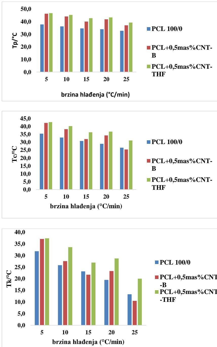
**Slika 26.** Ovisnost temperatura početka kristalizacije ( $T_p$ ), kraja kristalizacije ( $T_k$ ) i temperatuta kristalizacije ( $T_c$ ) za različite brzine hlađenja za čisti PCL i PCL+0,5mas% CNT nanokompozite dobivene umiješavanjem u Brabender gnjetilici i THF-u.
