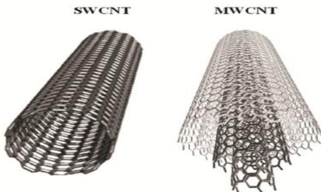
**Slika 5.** Prikaz strukture jednostjenih ugljikovih nanocjevčica (SWCNT) i višestjenih ugljikovih nanocjevčica (MWCNT)<sup>5</sup>.
