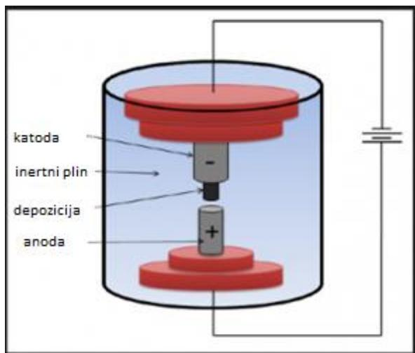
**Slika 6.** Prikaz sinteze nanocjevčica električnim lukom<sup>7</sup>.
