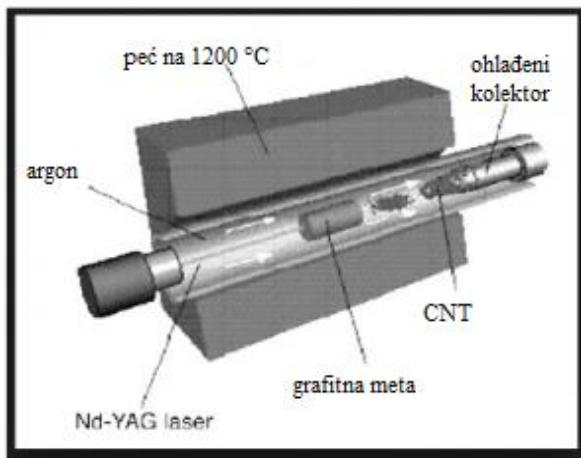
Slika 7. Prikaz sinteze nanocjevčica laserskom ablacijom<sup>7</sup>.
