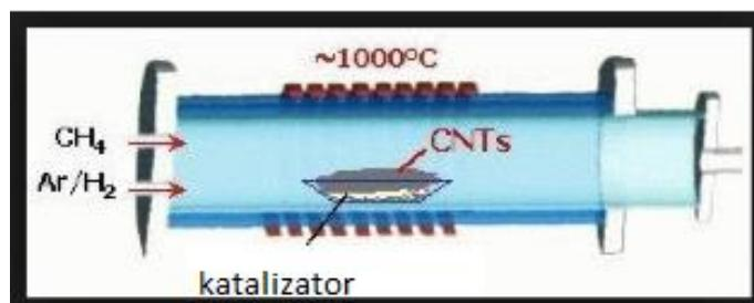
Slika 8. Prikaz sinteze nanocjevčica kemijskom depozicijom pare<sup>8</sup>.
