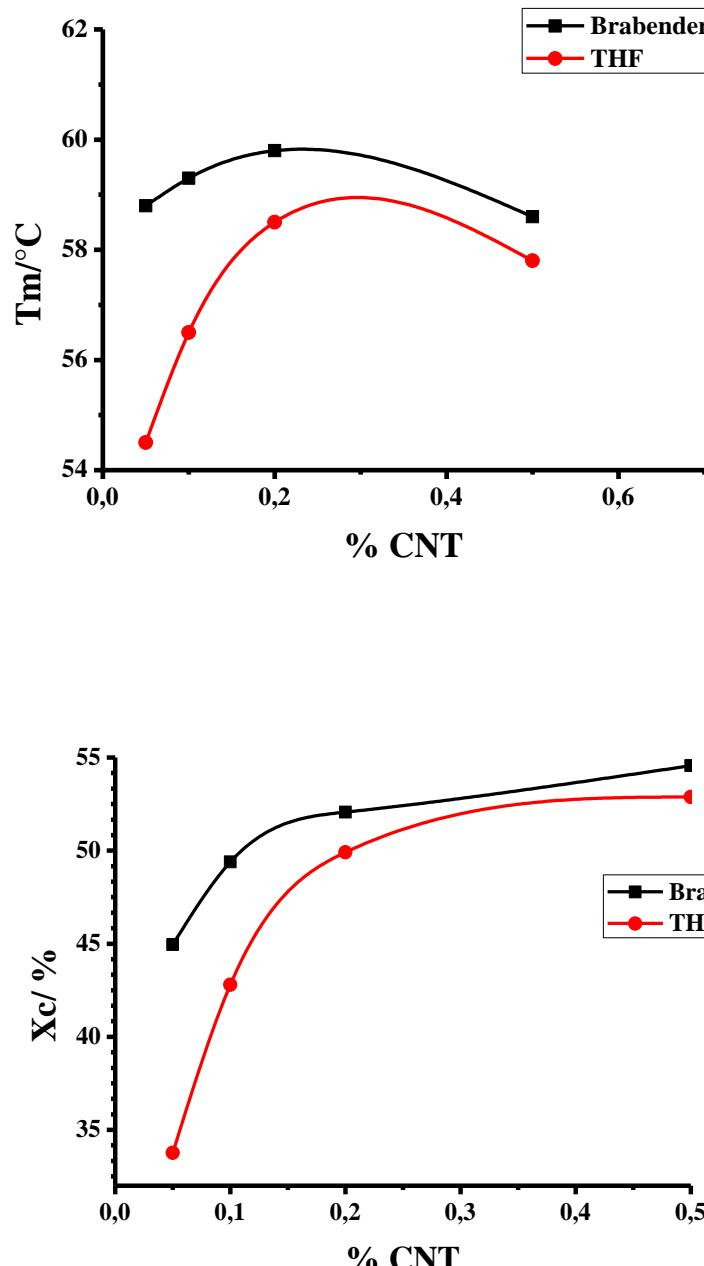
**Slika 24.** Vrijednosti temperature taljenja i stupnja kristalnosti u ovisnosti o udjelu CNT-a.
