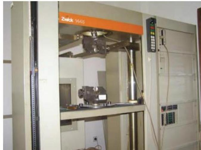
**Slika 17.** Univerzalna mehanička kidalica ZWICK 1445.
