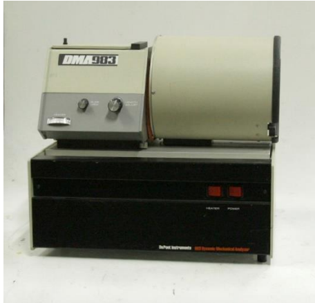
Slika 16. DMA 983, TA instrument 15 .
