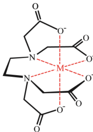
Slika 2.6. Kelatni kompleks EDTA i metalnog iona. 11
