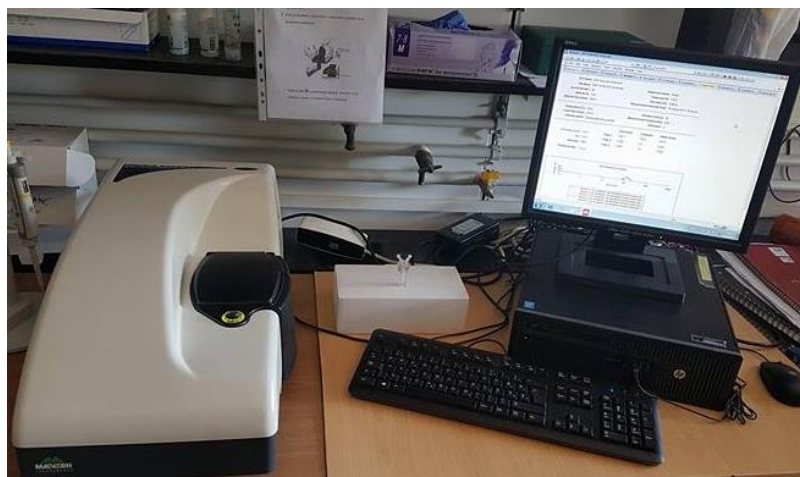
Slika 14. Malvern Zetasizer Nano ZS
