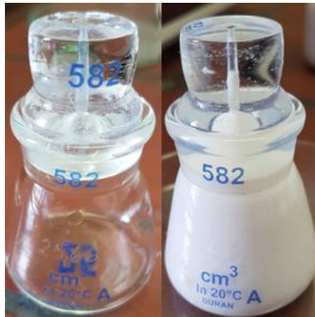
Slika 18. Piknometar za određivanje gustoće tekućina
