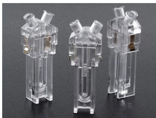
Slika 15. Jednokratne kapilarne ćelije za mjerenje zeta-potencijala DTS1061
