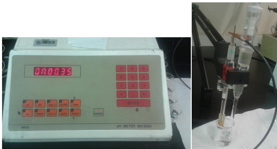
Slika 19. Prikaz aparature za mjerenje pH osjetljivosti zlatne elektrode oslojene polianilinom.
