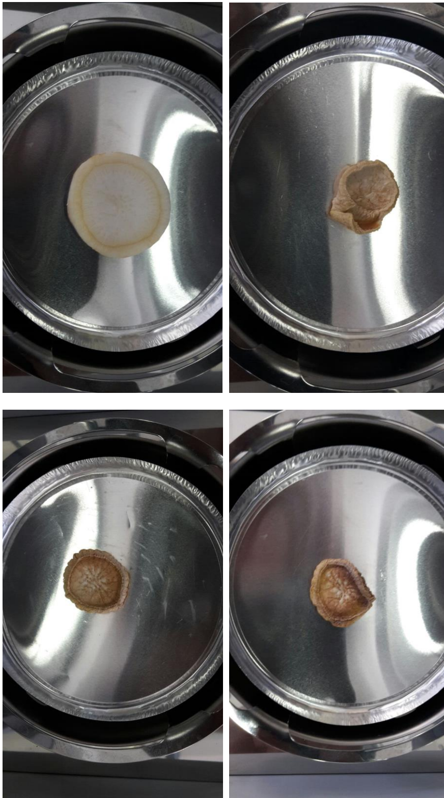
Slika 58. Uzorci korijena peršina prije i nakon sušenja u infracrvenom sušioniku pri 70 °C, 90 °C i 100 °C
