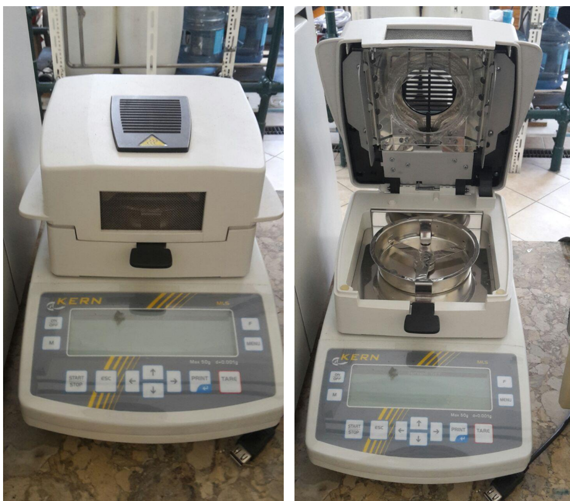
Slika 12. Infracrveni sušionik KERN Moisture analyser MLS-C
