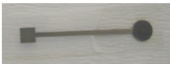
Slika 22. Ag|AgCl elektroda nakon nanošenja FeCl_3 .
