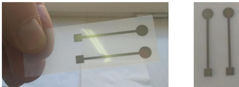
**Slika 19.** Ag elektrode printane ink-jet printerom.
