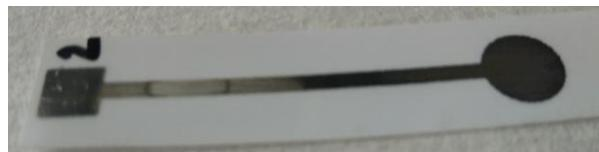
**Slika 24.** Ag elektroda nakon potenciostatske modifikacije.
