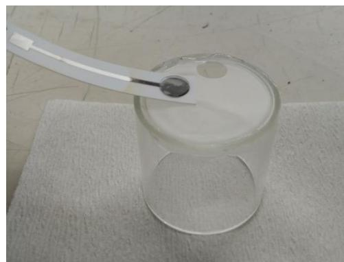
**Slika 20.** Membrana na bazi ionske tekućine.
