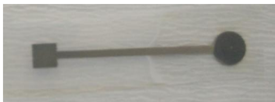
Slika 22. Ag|AgCl elektroda nakon nanošenja FeCl_3 .
