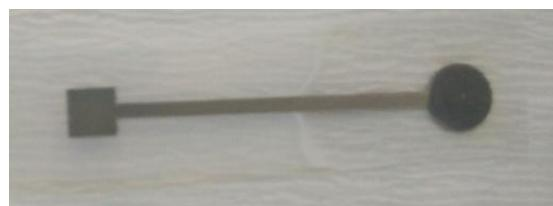
**Slika 22.** Ag|AgCl elektroda nakon nanošenja  $FeCl_3$ .
