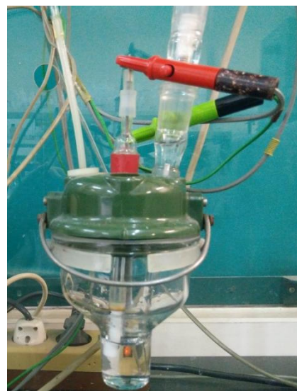
Slika 17. Potenciostat i osobno računalo (lijevo) te elektrokemijska ćelija s troelektrodnim sustavom (desno).
