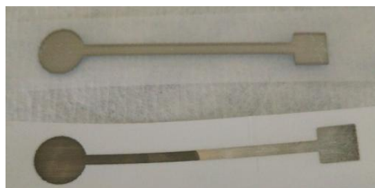
Slika 23. Usporedba Ag elektrode prije (gore) i nakon modifikacije cikličkom voltametrijom (dolje).
