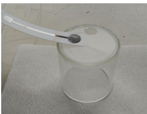
Slika 20. Membrana na bazi ionske tekućine.
