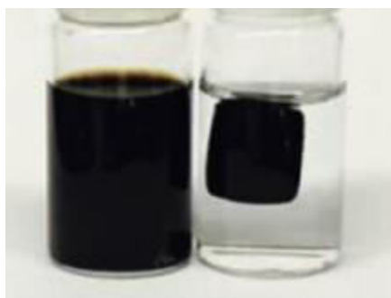
Slika 2.25. Prva bočica otopina GO prije redukcije, druga bočica rGO hidrogel nakon redukcije
