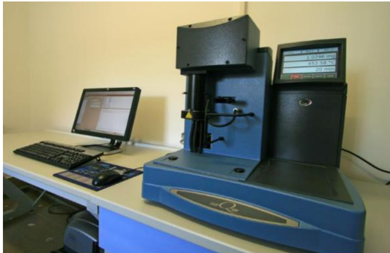
Slika 20. Termogravimetar, TA Instruments Q500
