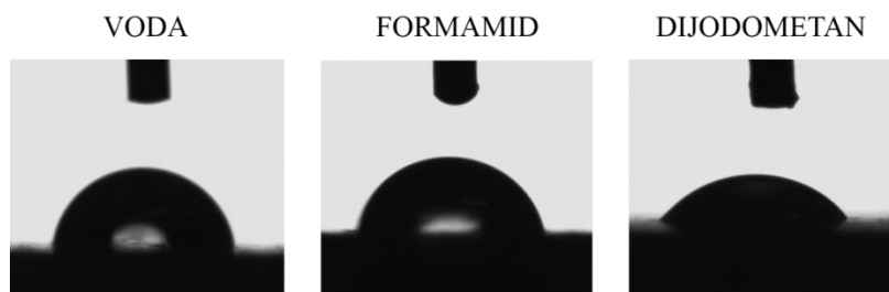
Slika 25. Prikaz kapljica testnih kapljevina na površini PCL polimera
