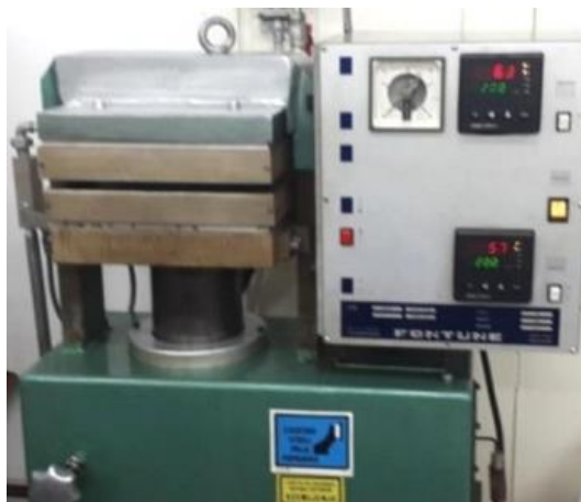
Slika 20. Hidraulička preša Fontune
