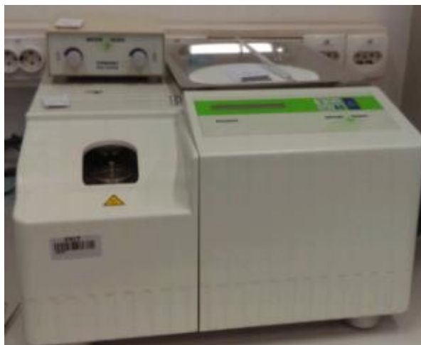
Slika 22. DSC uređaj Mettler Toledo DSC 823e
