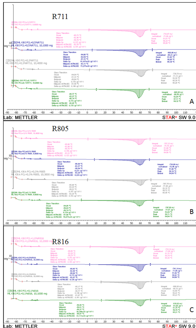
Slika 31. Usporedni DSC termogrami 2. ciklusa zagrijavanja a) PCL/R711 b) PCL/R805 c) PCL/R816 nanokompozita
