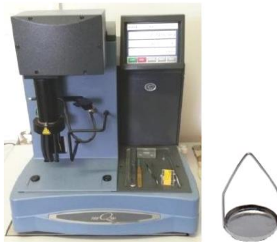
Slika 23. Termogravimetrijski uređaj TA Instruments Q500
