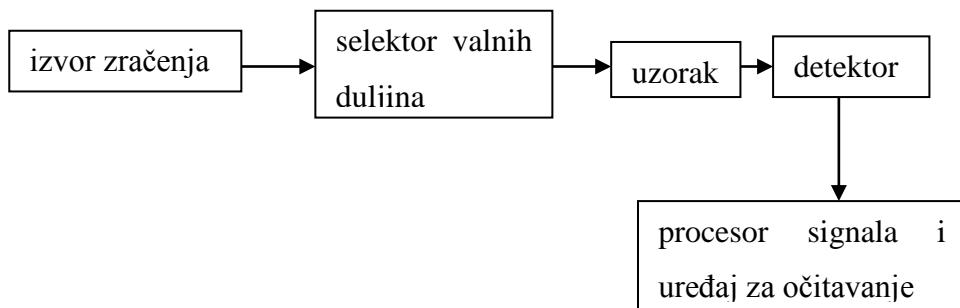
Slika 34. Prikazani su dijelovi koji čine instrument za apsorpcijsku spektrskopiju različitih tipova instrumenata za optičku spektroskopiju.
