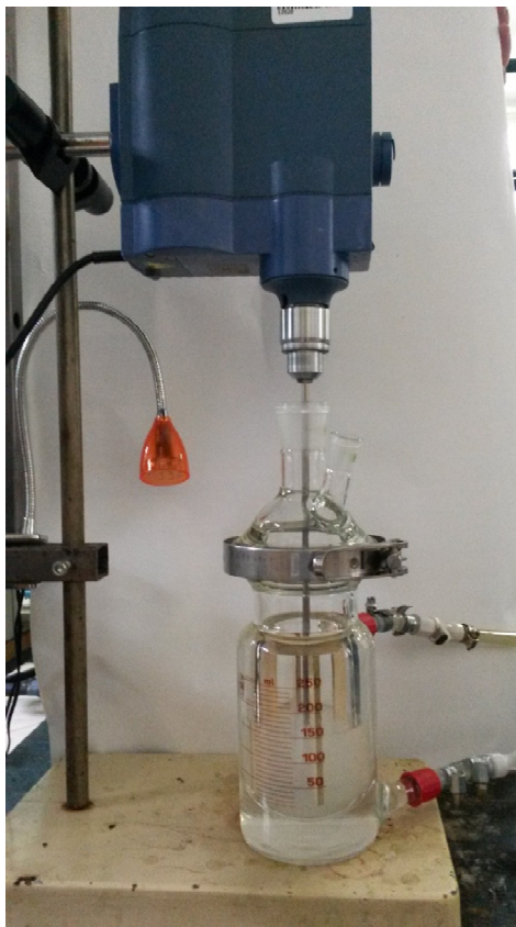
Slika 8. Kristalizator za provedbu eksperimenta
