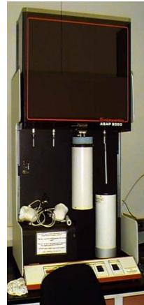
**Slika 19.** Uređaj za određivanje raspodjele volumena pora, ASAP 2000
