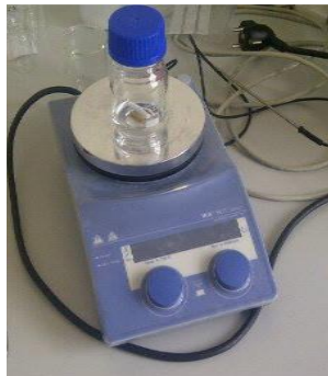
Slika 14. Polimerna otopina PCL-a na magnetskoj miješalici
