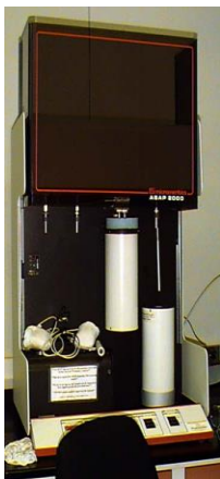
Slika 19. Uređaj za određivanje raspodjele volumena pora, ASAP 2000
