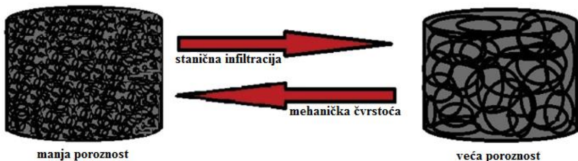
Slika 6. Utjecaj poroznosti na svojstva nosača [21]
